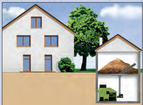
Beispiel: Siloaustragung aus einem Spänesilo mittels Schrägschnecken-Austragung
