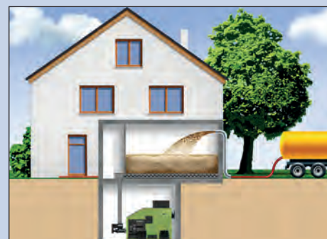
Beispiel: Pelletlagerraum mit Einblasvorrichtung
