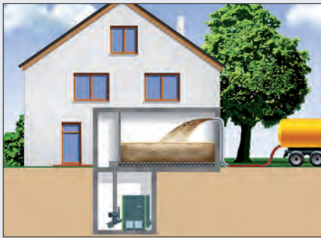
Beispiel: Pelletlagerraum mit Einblasvorrichtung
