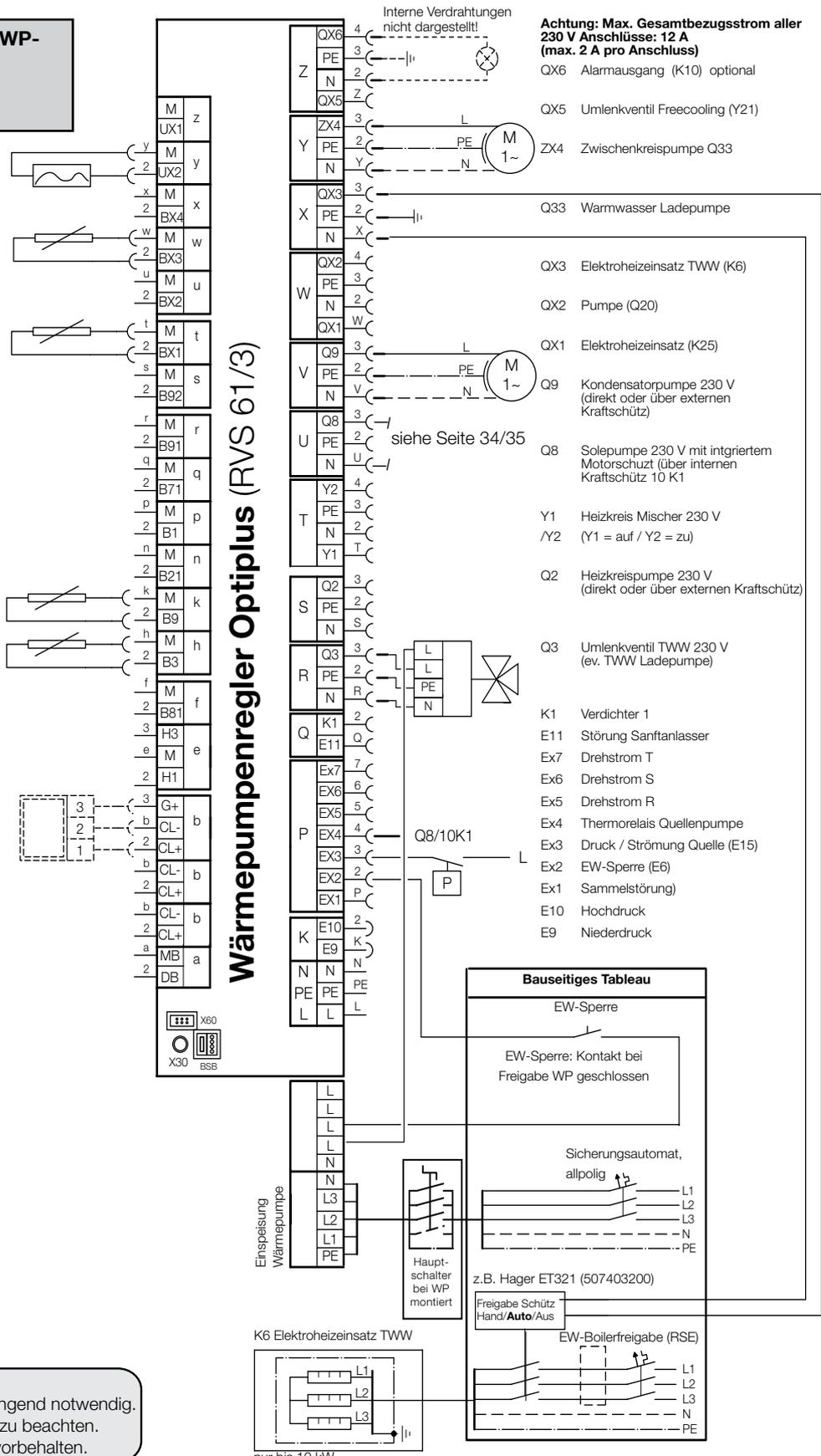
**Wärmepumpenregler Optiplus (RVS 61/3)**
