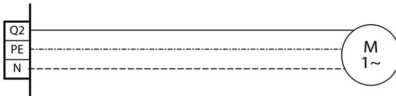
Heizkreispumpe 230 V mit:
