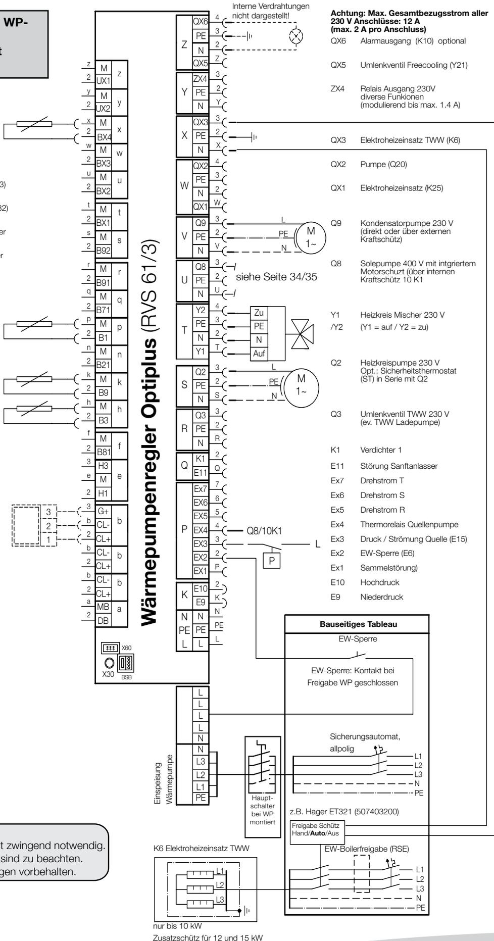
**Achtung: Max. Gesamtbezugsstrom aller 230 V Anschlüsse: 12 A (max. 2 A pro Anschluss)**
