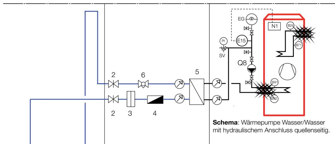
Schema: Wärmepumpe Wasser/Wasser mit hydraulischem Anschluss quellenseitig.
