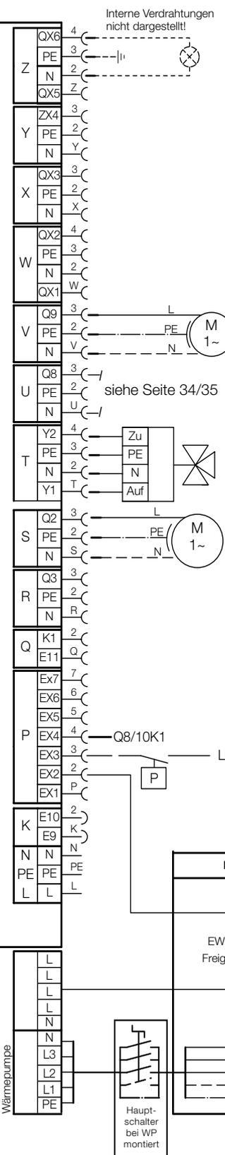
**Achtung: Max. Gesamtbezugsstrom aller 230 V Anschlüsse: 12 A (max. 2 A pro Anschluss)**
